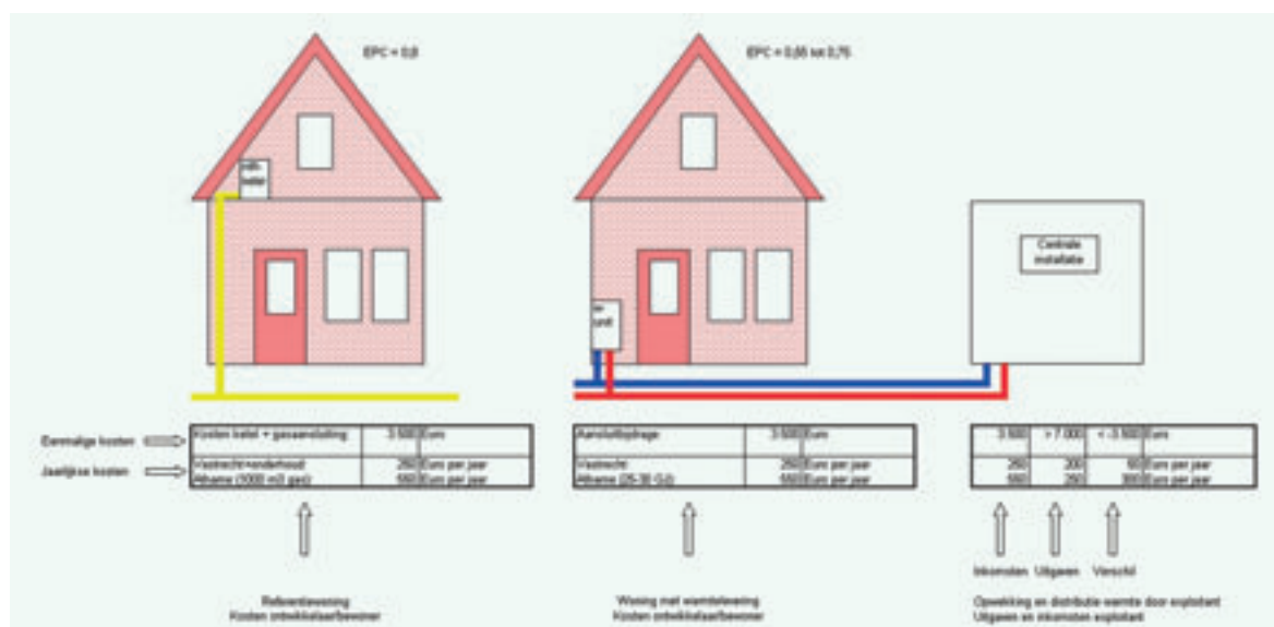
1. Vergelijking van een referentiewoning (met een hr-combiketel) met een warmtewoning.
