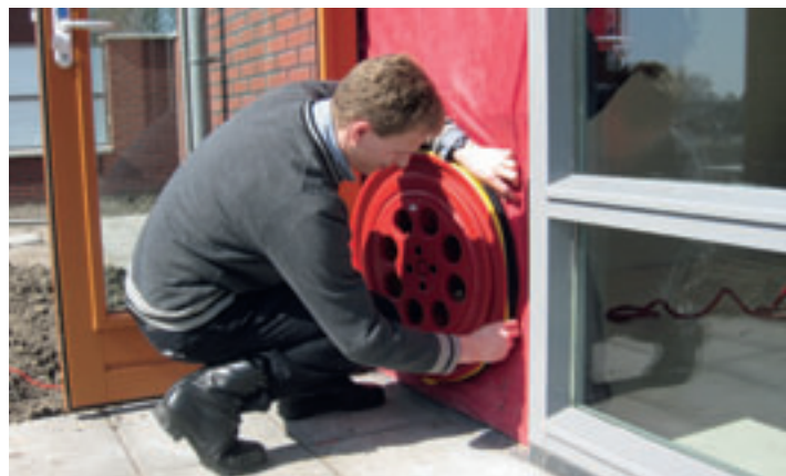
Uitvoering van de blowerdoortest.
