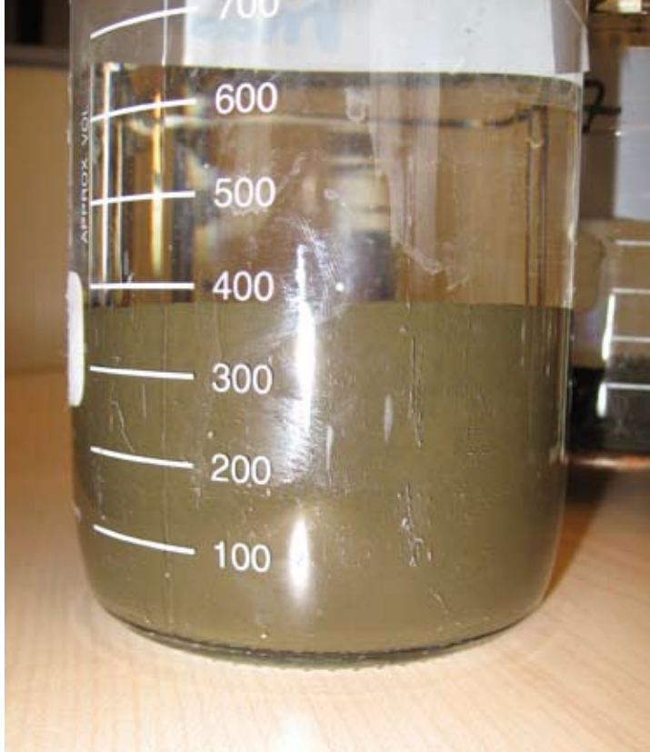
■ Aansluitingen klimaatpanelen (links) en slib vrijgekomen na het spoelen van de installatie (rechts).
