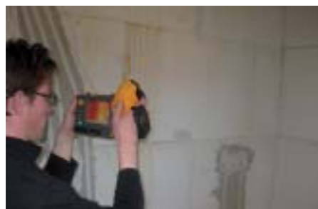
Op zoek naar warmtelekken met een infrarood camera
