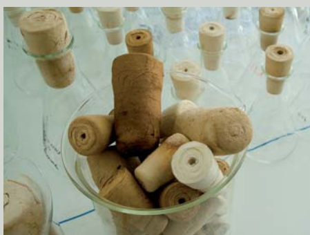
Speciale luchtdoorlatende doppen op deze erlenmeyers voor algenonderzoek. ^
