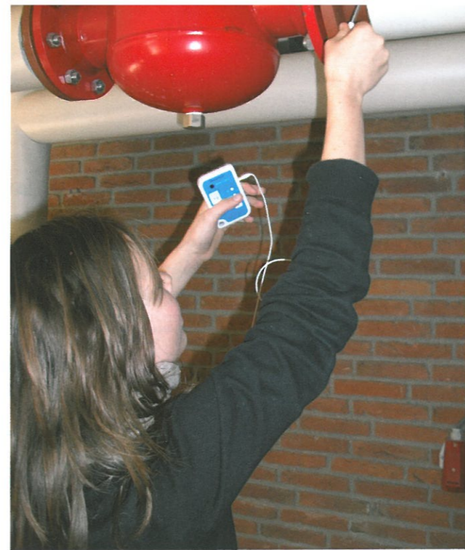
■ Maartje Oosterink plaatst een temperatuurlogger op een cv-leiding.
