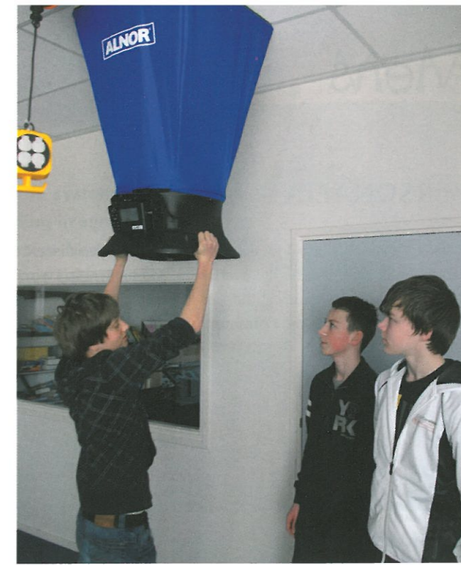
■ Nordy Visser, Bas Schinkel en Björn Tijhuis meten het ventilatie-debiet in de onderbouw.
