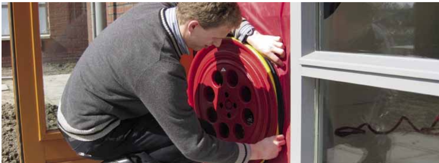
UITVOERING VAN DE BLOWERDOORTEST.
