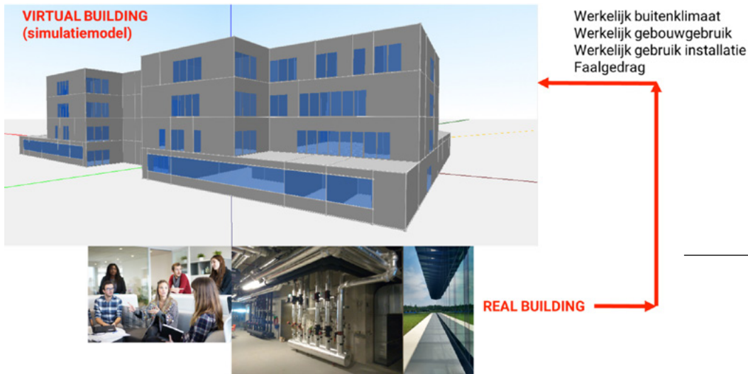
Figuur 2: Fysische simulatie-modellen worden gekalibreerd op basis van onder meer het gebouwgebruik en het gebruik van de installatie
